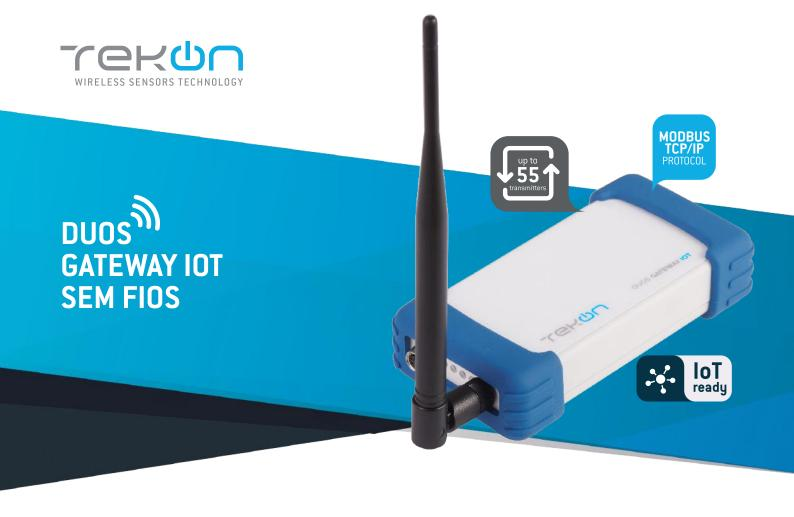
O DUOS Gateway loT Sem Fios é uma solução de fácil utilização, especialmente projectada para criar uma rede de monitorização de dados físicos, como temperatura e humidade relativa.
