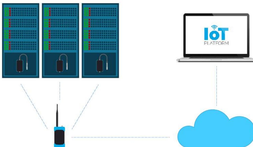
Figura 1 - Exemplo de arquitetura da solução sem fios DUOS HYGROTEMP
