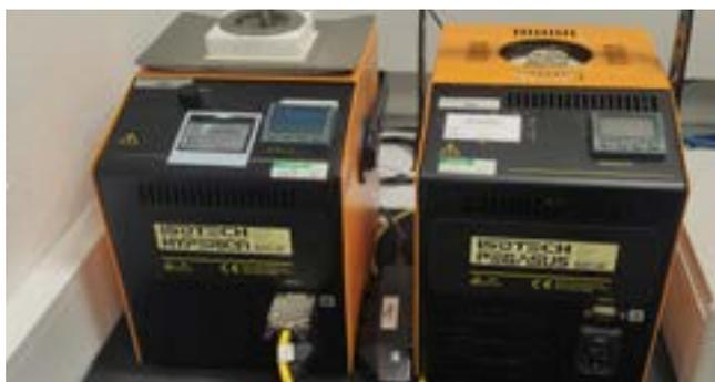
Os fornos a seco e banho a óleo, são equipamentos de elevada precisão e estabilidade utilizados nas validações e caracterizações internas.
